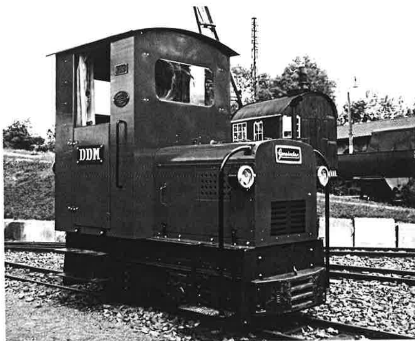
Petite locomotive diesel de chantier (Feldbahnlok) - photo Marc Symons. Voir aussi article page 13.
